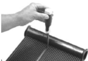
2. Utiliser un ciseau à bois de 6mm Placer le côté plat du ciseau près de la tête, découper le tube endommagé, au près de la tête que possible. Un trou rond sera créé dans tête du capteur
