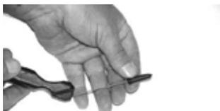
3. Vaporiser le manchon de caoutchouc à l'aide de lubrifiant et le glisser sur une clé six pans de 2mm Étirer et attendrir le manchon caoutchouc à quelques reprises sur la clé six pans 2mm
