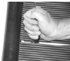
5. Pousser le bouchon de réparation de plastique fermement dans le manchon de réparation. Le trou est maintenant colmaté et ne fuira plus
