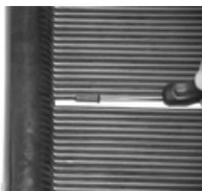
4. Insérer délicatement le manchon de caoutchouc dans le trou créé en enlevant le tube, jusqu'à ce que l'on puisse apercevoir la tête
